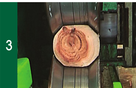
3 ローラーで圧縮加工
