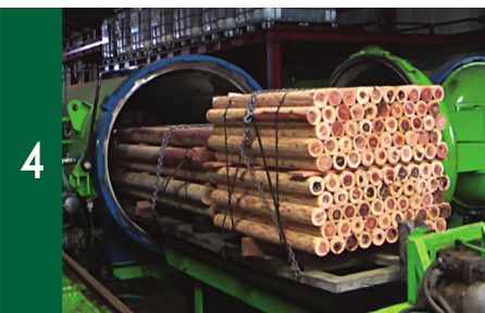
4 タンクに「圧縮加工処理材」を搬入
